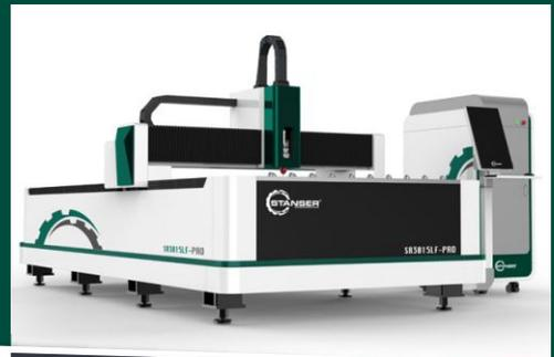
Cabezal de Raytools focalización automática. Estructura de 4,500 kilos 10mm para la mayor estabilidad y resistencia a la torsión del mercado, un equipo lo suficientemente robusto como para manejar potencias de hasta 8,000w.
