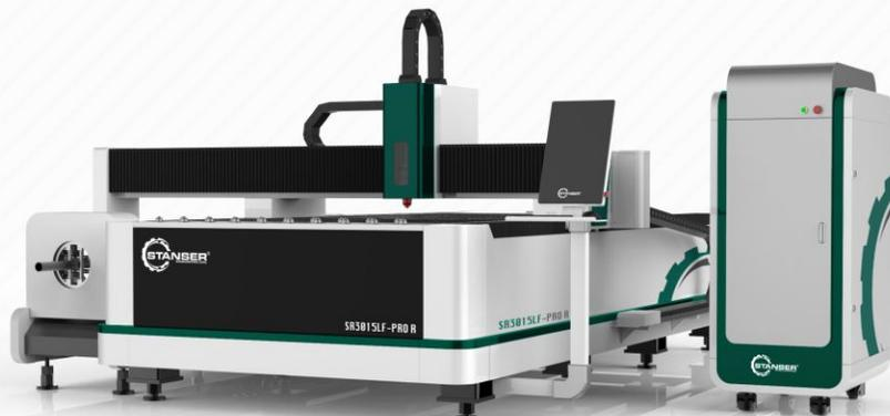
El SR3015LF-PRO R es un cnc láser fibra óptica de corte de gama alta, soporta resonadores de hasta de 8,000w para el trabajo mas pesado, y además incorpora una mesa rotativa para tubo de 3 o 6 metros, este equipo maneja las mas altas velocidades de corte y los mejores componentes. Domina tu mercado® con Stanser.
